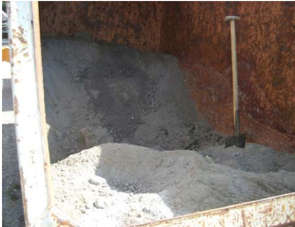
Abb. 8: Stabilisat aus Biomasse-Aschen-Filterstaub im Container
