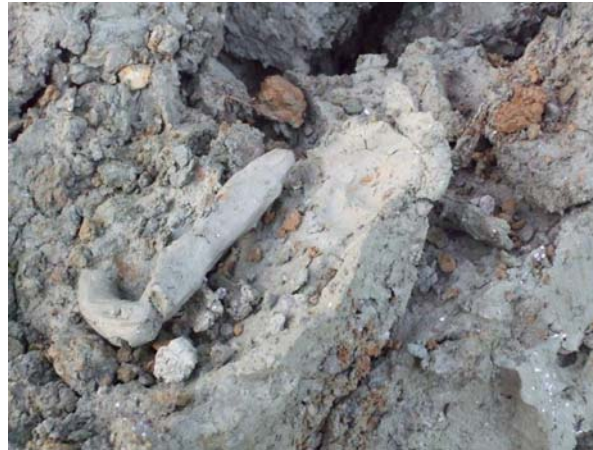
Abb. 5: Mergel vor dem Einbau mit Ausrollprobe
