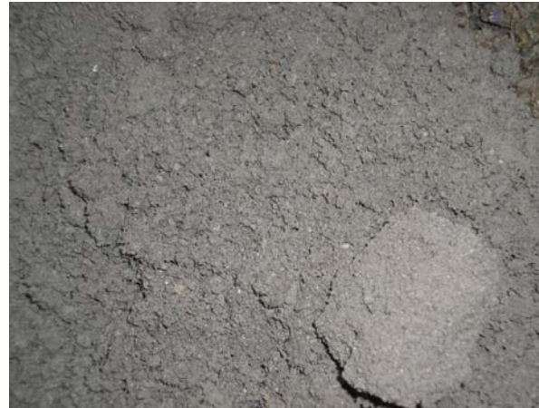
Abb. 9: Stabilisat aus Biomasse-Aschen-Filterstaub, Nahaufnahme
